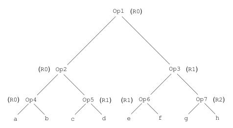
;; partie gauche LOAD @a, RO Op4 @b, R0 LOAD @c, R1 Op5 @d, R1 Op2 R1, R0 ;; partie droite LOAD @e, R1 Op6 @f, R1 LOAD @g, R2 Op7 @h, R2 Op3 R2, R1 ;; enfin : Op1 R1, R0
