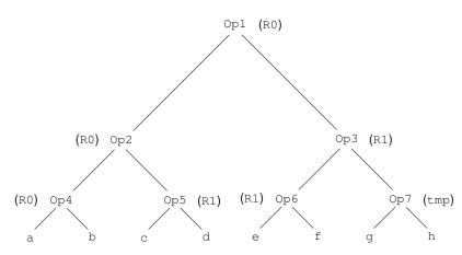
;; partie gauche LOAD @a, RO Op4 @b, R0 LOAD @c, R1 Op5 @d, R1 Op2 R1, R0 ;; partie droite LOAD @g, R1 Op7 @h, R1 STORE R1, @tmp LOAD @e, R1 Op6 @f, R1 Op3 @tmp, R1 ;; enfin : Op1 R1, R0
